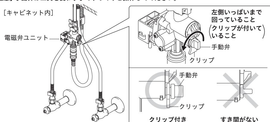
③ 湯水の止水弁を開き、レバーハンドルを開きます。
