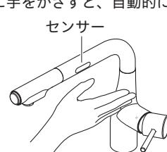
⑤ センサーまたはレバーハンドルを閉じて止水し、接続部からの水漏れがないことを確認してください。
