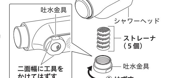
④ シャワーフェイスのねじを緩め、ねじを引っぱりはずして、ストレーナ(2個)を取りはずします。
