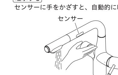
[止水する] センサーに手をかざすと、自動的に止水します。
