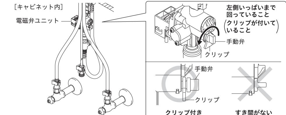
③ 湯水の止水弁を開き、混合栓レバーハンドルを開きます。
