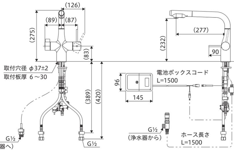
●水栓取付面からシンク下の底板(棚板)までの距離が575mm以上ないと、ホース収納時に底板(棚板)との干渉が大きくなり、使用上問題はありませんが、ホース収納性が悪くなります。
