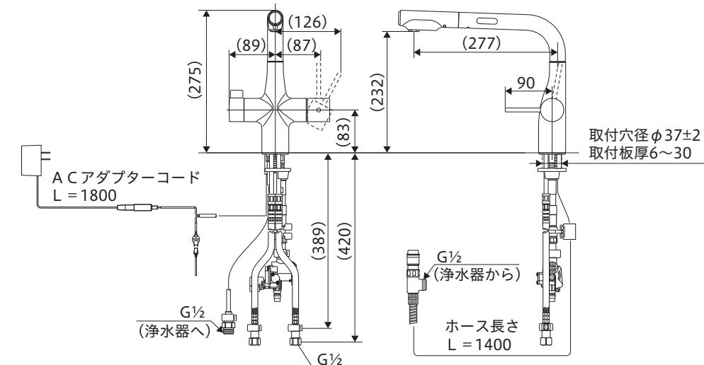
●水栓取付面からシンク下の底板(棚板)までの距離が575mm以上ないと、ホース収納時に底板(棚板)との干渉が大きくなり、使用上問題はありませんが、ホース収納性が悪くなります。
