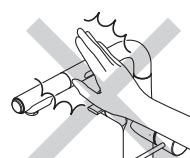
●吐水口がシンクより飛び出すような施工はしないでください。
