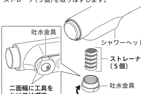
④ シャワーフェイスのねじを緩め、ねじを引っぱりはずして、ストレーナ(2個)を取りはずします。
