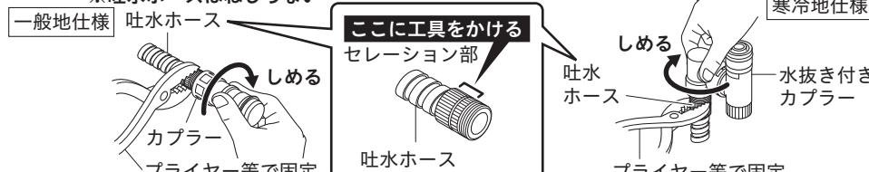
④ カプラーのキャップをはずし、スライダーを下に下ろしてから、本体のプラグヘカチッと音がするまで押し込みます。(スライダーがすでに下りている場合もあります。寒冷地仕様の場合はエルボが下向きになっていることを確認します。)
