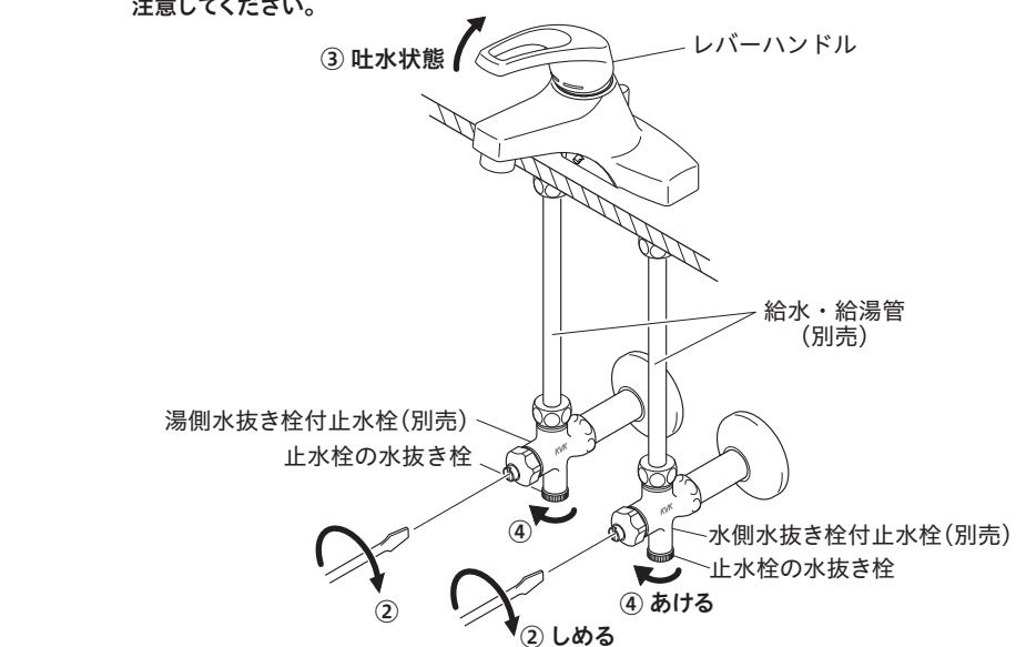
【お願い】上記と逆の手順で操作して通水を再開してください。必ず水抜き栓がしまっていることを確認して、レバーハンドルを下げて(止水状態)から通水してください。
