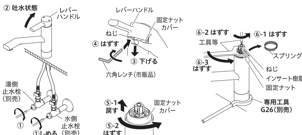
水栓本体内部のメンテナンス後は、はずした逆の手順で組み立ててください。
