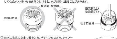
ヘッドに散水板をはめてからシャワーヘッドに手締め後、工 具で約1/3回転(約120度)増し締めしてください。 (締め付けトルクの目安は約75N·cm)
