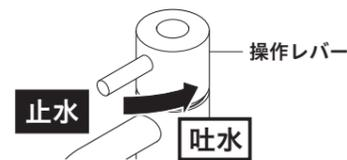
**【注意】** 操作レバーは無理な力を加えずゆっくり操作してください。急な操作や無理な力での操作はウォーターハンマー(水撃)音が発生し、配管からの漏水により家財などを濡らす財産損害発生のおそれがあります。
