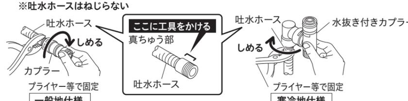
② カプラー(一般地仕様のみ)のキャップをはずし、スライダーが下におりていることを確認してからプラグへカチッと音がするまではめ込みます。(寒冷地仕様の場合はエルボが下向きになっていることを確認します。)取り付け後、カプラー(寒冷地仕様は水抜き付きカプラー)を引っばってはずれないことを確認します。
