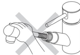
**【注意】** 本体の開口部へ直接湯水をかけないでください。漏水で家財などを濡らす財産損害発生のおそれがあります。水受けトレーの設置をしてください。
