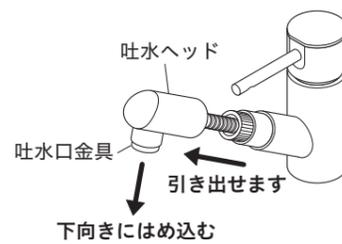
**【注意】** 吐水ヘッドを引き出しすぎないでください。ホースが戻しにくくなったり、ホース損傷により漏水で家財などを濡らす財産損害発生のおそれがあります。
