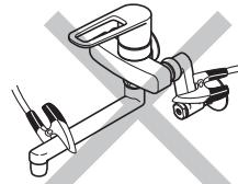
通電すると水栓が発熱し、破損して漏水で家財などを濡らす財産損害発生のおそれがあります。
