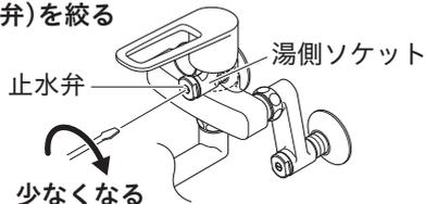
吐水温度が低い場合は、水側ソケット(止水弁)を絞る
