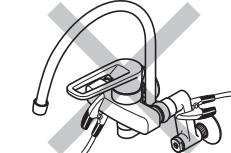
通電すると水栓が発熱し、破損して漏水で家財などを濡らす財産損害発生のおそれがあります。
