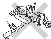
**🚫 禁止** [寒冷地仕様の場合] 水抜き栓は水抜き以外の目的で開けないでください。
