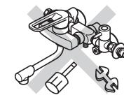
**🚫 禁止** 配管などの解氷のため、解氷機を使用する場合は、水栓には絶対に通電しないでください。
