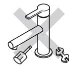
配管などの解氷のため、解氷機を使用する場合は、水栓(給水・給湯管含む)には絶対に通電しないでください。
