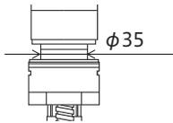
② カウンターの取付穴径の確認をしてください。(穴径によって使用する品番が異なります。)
