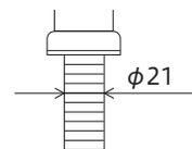
② カウンターの取付穴径の確認をしてください。(穴径によって使用する品番が異なります。)
