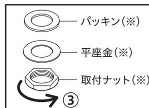
座金より下側は水栓に同梱されている部品(※)を使用します。製品により部品が異なる場合があります。製品の固定方法は、水栓に同梱されている施工説明書を参照してください。
