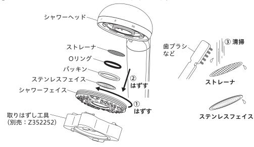
④ シャワーフェイスにステンレスフェイス・パッキンを入れます。 ※ステンレスフェイスは「X」がある面を内側に向けてください。 ⑤ シャワーヘッド中央のくぼみにストレーナ・〇リングを入れます。
