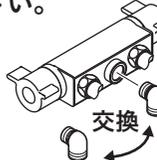
必ず守る</p> <p>交換</p> <p>交換しないとシャワーエルボが破損し、漏水して家財などを濡らす財産損害発生のおそれがあります。</p> | <p>使用後は、必ずシャワーを出の状態にして、水栓金具本体のハンドルで止水してください。</p> <p>
