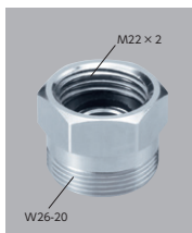
異径アダプター Z410828 ¥720(税込¥792) [1] ■M22×2のおねじにW26-20のシャワーエルボナットが接続できます。
