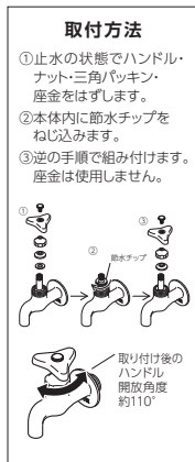
取付方法 ①止水の状態ではハンドル・ナット・三角パッキン・座金をはずします。 ②本体内に節水チップをねじ込みます。 ③逆の手順で組み付けます。座金は使用しません。 取り付け後のハンドル開放角度 約110°
