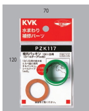
根元パッキン13(1/2)用 PZK117 ¥430 (税込¥473) [10]- ■シールテープ1m付 給水栓を取り付ける時、給水栓と壁の間のすき間及び向き合わせの為に使用するパッキンです。根元パッキンを入れ、シールテープを巻いてください。
