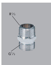
ニップル13(1/2)用 Z1015 ¥460 (税込¥506) [30][50] ■呼び13管用めねじ同士の接続 ■黄銅製
