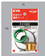
水栓プッシング座金付き 20(3/4)×13(1/2) PZ1022 (R3/4×R1/2) ¥810 (税込¥891) [10]- ■給水座金9mm ■1mシールテープ付 ■呼び20管用めねじと呼び13管用めねじとおとす ■黄銅製
