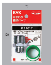
異径ニップル20(3/4)×13(1/2)用 PZ1017 ¥880 (税込¥968) [6]- ■1mシールテープ付 ■呼び13管用めねじと呼び20管用めねじの接続 ■黄銅製
