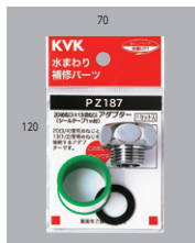
20(めねじ)×13(おねじ)アダプター PZ187 ¥940 (税込¥1,034) [10]- ■1mシールテープ付 ■G3/4×G1/2 ■黄銅製
