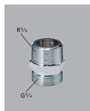
ニップル20(3/4)用 Z1016 ¥620 (税込¥682) [15][50] ■呼び20管用めねじ同士の接続 ■黄銅製
