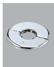
シーリングプレート Z1055 13(1/2)用 内径24・外径68 ¥400 (税込¥440) [20]- Z1055-20 20(3/4)用 内径31・外径77 ¥400 (税込¥440) [20]- シーリングプレートは配管済みのパイプ床面と壁面に取り付ける座金です。
