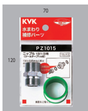
ニップル13(1/2)用 PZ1015 ¥610 (税込¥671) [10]- ■1mシールテープ付 ■呼び13管用めねじ同士の接続 ■黄銅製
