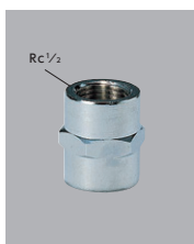
内ニップル13(1/2)用 Z1019 ¥790 (税込¥869) [40]- ■呼び13管用めねじ同士の接続 ■黄銅製
