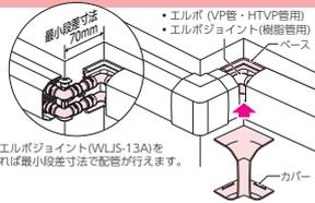
※壁貫通エルボジョイント(WLJS-13A)を使用すれば最小段差寸法で配管が行えます。
