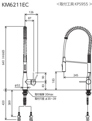
※シャワーヘッドをステアから取りはずすと、ヘッド収納時より全高が高くなります。施工時には、取りはずした際、周辺設備と干渉しない十分な高さを確保してください。寸法はヘッドを取りはずした時の、全高の目安としてください。
