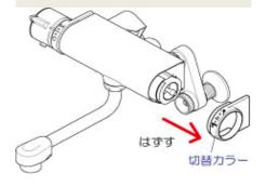
4 切替側ナットをスパナなどで 矢印の方向へ回してゆるめ、 はずします。
