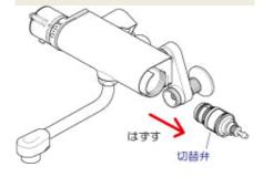
切替弁を水洗いで清掃します。 切替弁に劣化・摩耗がみられ る場合、新しい切替弁を用意し ます。
