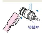
取りはずした逆の手順で組み付け、切替弁が「止」の位置にあることを確認して止水弁をあけてください。 パイプまたはシャワーから水もれがないかを確認してください。
