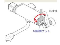
5 切替弁を引き抜いて、 はずします。
