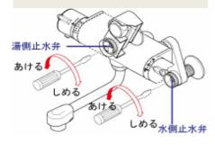
2 切替ハンドルのキャップ切り欠き部に先のとがったものを引っ 掛けてはずし、切替ハンドルを はずします。
