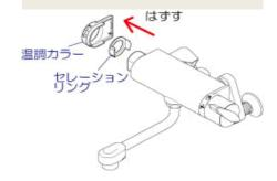
4 温調ナットを矢印の方向 へ回して、はずします。
