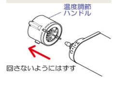
4 ハンドルの「40」の目盛を 表示ポイントに合わせては め、キャップで固定します。
