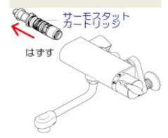
サーモスタットカートリッジを水洗いで清掃します。サーモスタットカートリッジに劣化・破損がみられる場合、新しいサーモスタットカートリッジを用意します。
