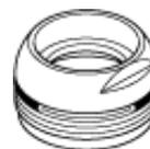
**4** 固定ナットを取り外したらカートリッジを取り外します。
