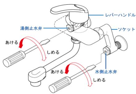
**2** キャップの切欠部をドライバーなど先のとがった物ではずし、ドライバーでビスをゆるめレバーハンドルを取り外します。
