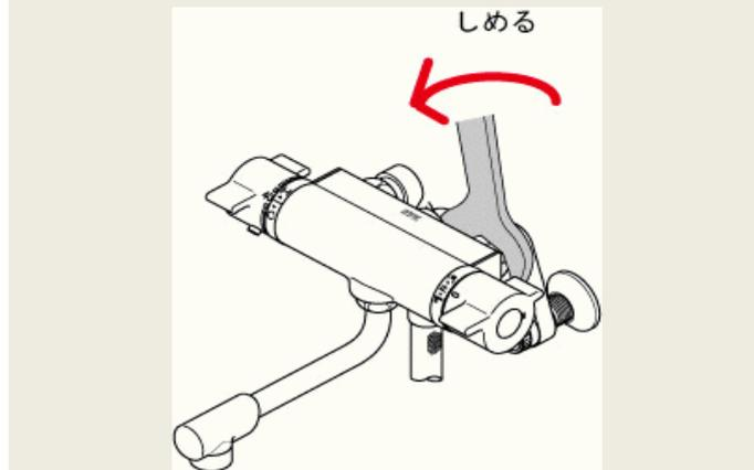
12 ソケットカバーを止水弁の位置にはめ込んでから、矢印の方向に回します。この時、ソケットカバーのツメがナットの後ろにくるようにはめ込んで下さい。
