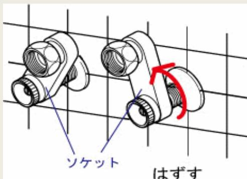
**6** ソケットがはずれたら、配管側のゴミなどをきれいに取り除いてください。※ゴミがあると通水時の水もれの原因になります。
