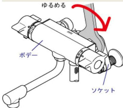
KF112,KF120,KF19Nなどの場合は、ナットをゆるめる方向が反対となります。
