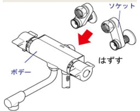
**5** ソケットを矢印の方向へ強く回してはずします。現在お使いの配管が古い場合、破損する恐れがあります。お近くの水道工事店へご相談ください。
