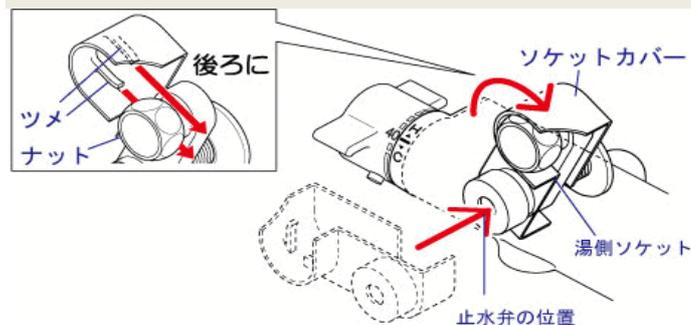
13 取り付けが完了したら元栓を開け、接続部からの水もれがなければ完了です。
