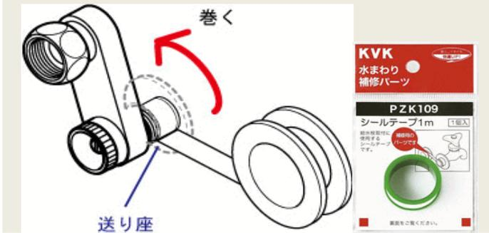
8 ソケットを配管側へ矢印の方向へ回して、ねじ込んでください。
